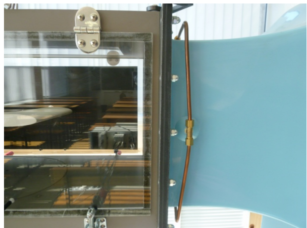
Рис. 5. Коллектор приемников статического давления на входе в камеру визуализации
