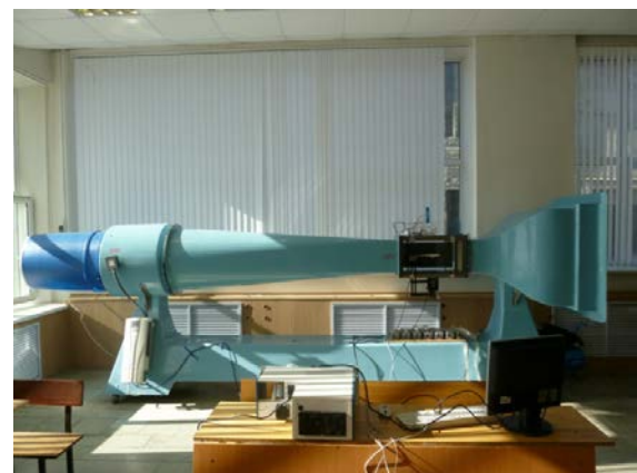
Рис. 1. Внешний вид аэродинамической трубы Aerolab EWT
