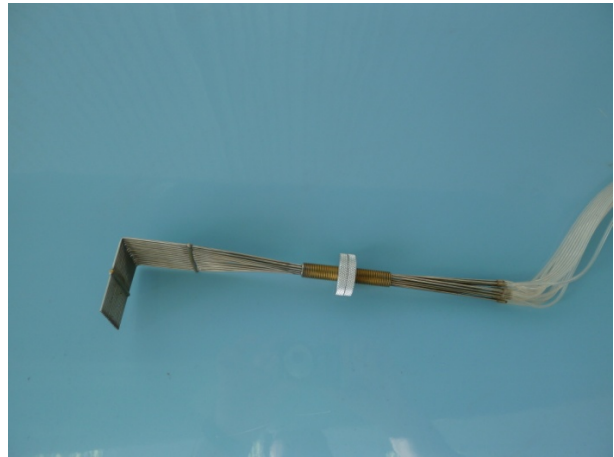
Рис. 4. Гребенка приемников полного давления для исследования распределения давлений в аэродинамическом следе модели
