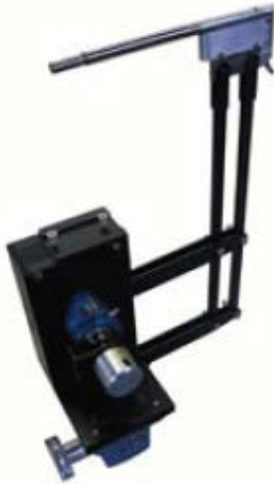
Рис. 2. Система позиционирования аэродинамической трубы Aerolab EWT
