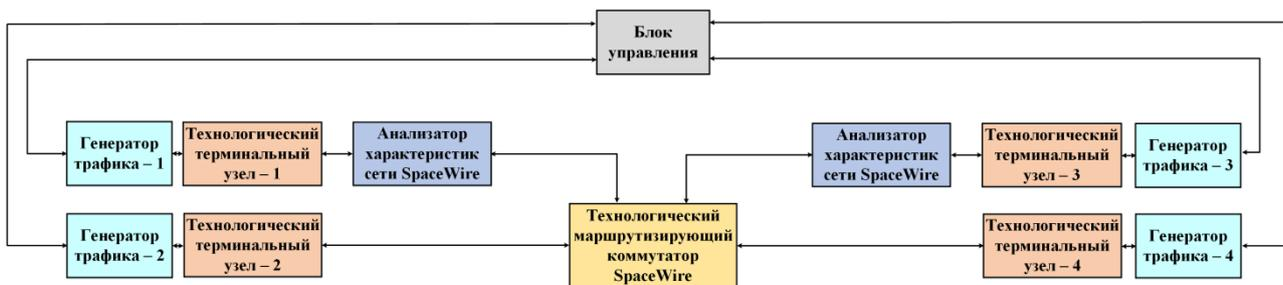
**Рисунок 2.** Пример построенной при помощи стенда модели бортовой информационной сети для отработки системы.
