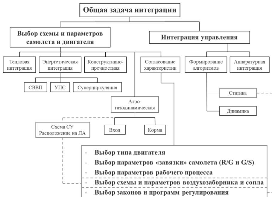
Рисунок 1. Различные аспекты интеграции самолёта и силовой установки.
