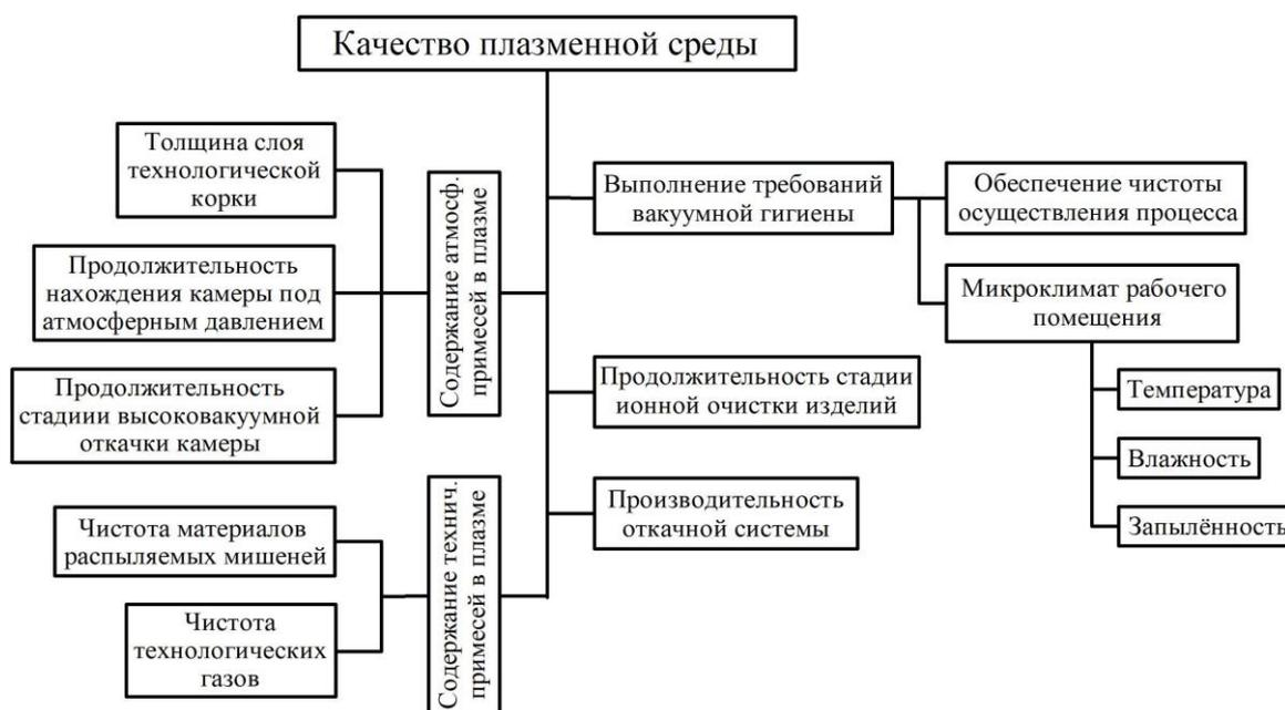
**Рисунок 1.** Структурный комплекс показателей качества процесса ионно-плазменного напыления.
