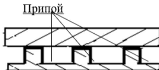
**Рисунок 1.** Типовое паяное соединение с использованием серебряного покрытия.
