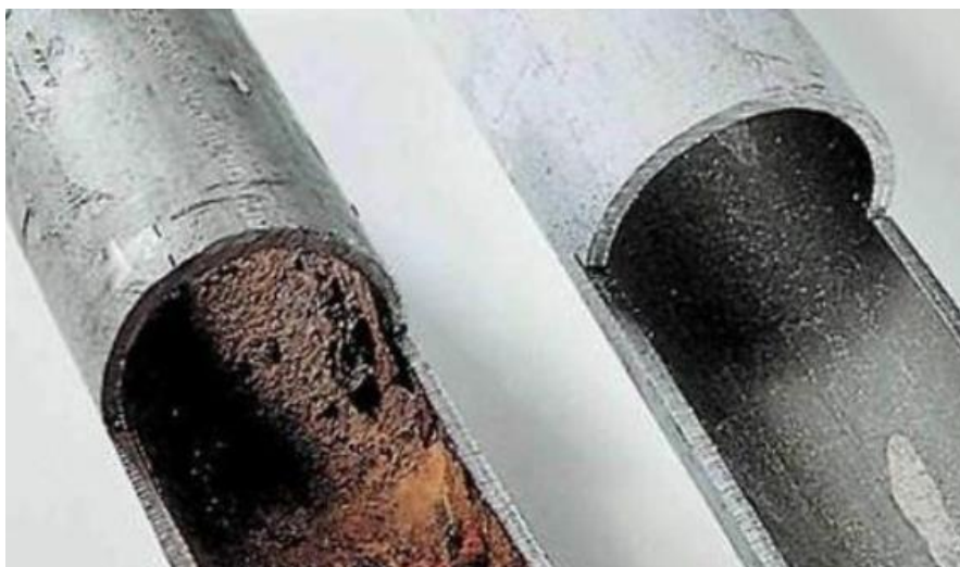
Рисунок 6. Визуальный осмотр образцов с электрохимической защитой и без нее.
