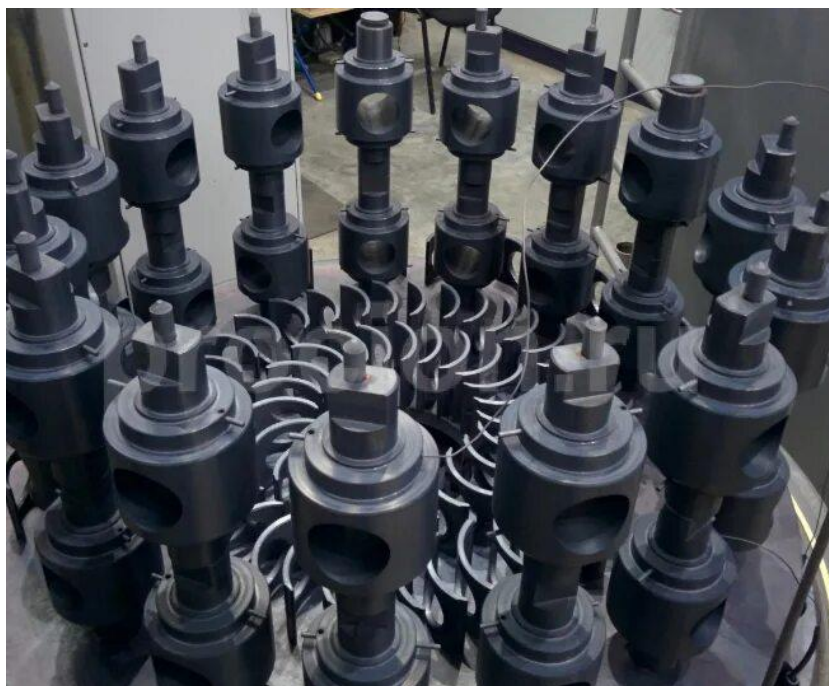
Рисунок 9. Детали после ионно-плазменного азотирования.
