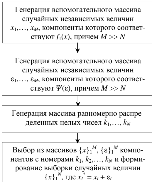
Рис. 3. Алгоритм генерации случайных чисел «с перемешиванием»
