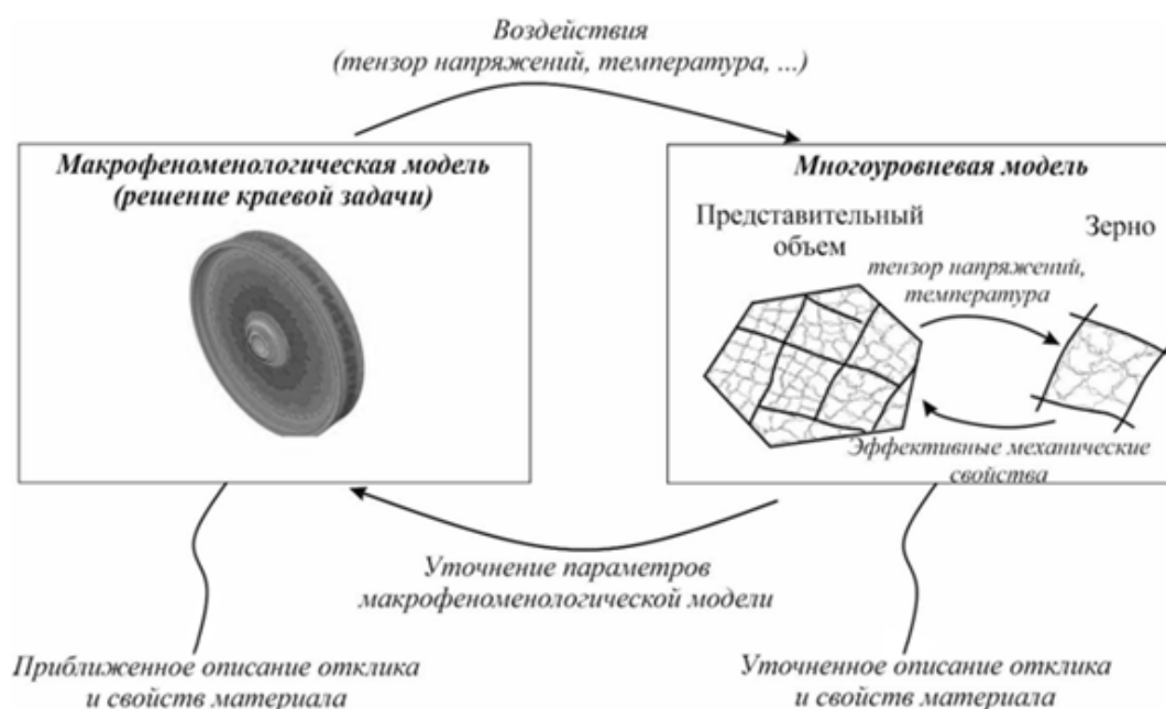
Рисунок 1. Схема взаимодействия между многоуровневой конститутивной моделью и феноменологической, применяемой для решения краевой задачи.
