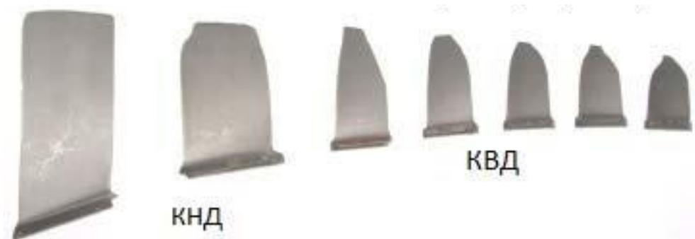
**Рисунок 2.** Характер предельного износа рабочих лопаток компрессора со 2-й по 8-ю ступени.
