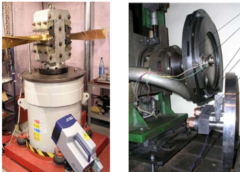
Рис. 6. Испытания лопаток на электродинамическом (слева) и воздушном (справа) вибростендах
