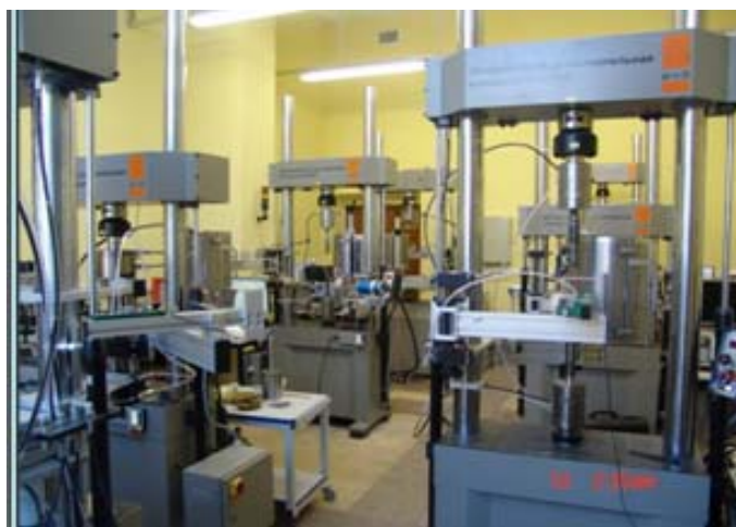
Рис. 2. Сервогидравлические машины для испытаний на малоцикловую усталость и трещиностойкость
