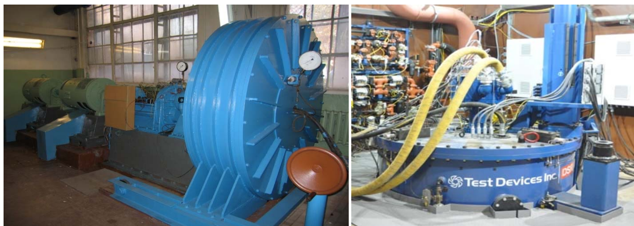
Рис. 7. Разгонные стенды с горизонтальной осью вращения (а) и вертикальной осью вращения (б)
