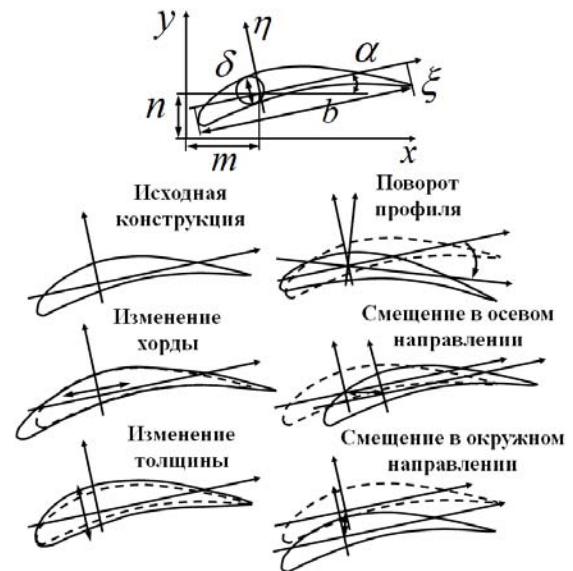
Рис. 3. Схема параметризации сплошного сечения
