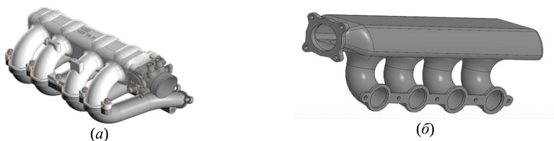
Рисунок 1. Стандартный и доработанный ВК: (а) стандартный; (б) доработанный.
