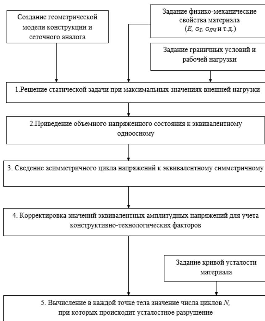
Рисунок 5. Структура расчета усталостной прочности при многоциклового нагружении.
