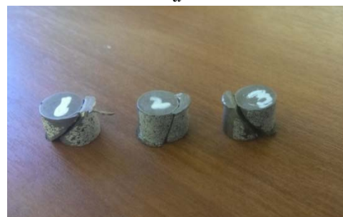
Рис. 7. Стандартные образцы на сжатие: a – до испытаний; б – после испытаний
