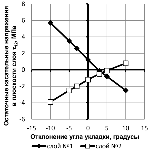
Рис. 3.7. Зависимость остаточных касательных напряжений \tau_{12} в слоях 5-и слойной консольной балки от величины отклонения угла укладки внешнего слоя \Delta\phi
