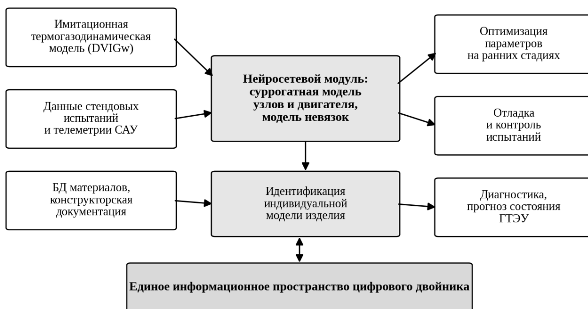
Рисунок 2. Архитектура гибридного нейросетевого модуля в составе цифрового двойника ГТД.
