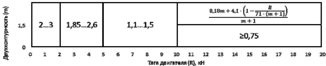
Рис. 2. Нормы требуемой мощности пускового устройства
