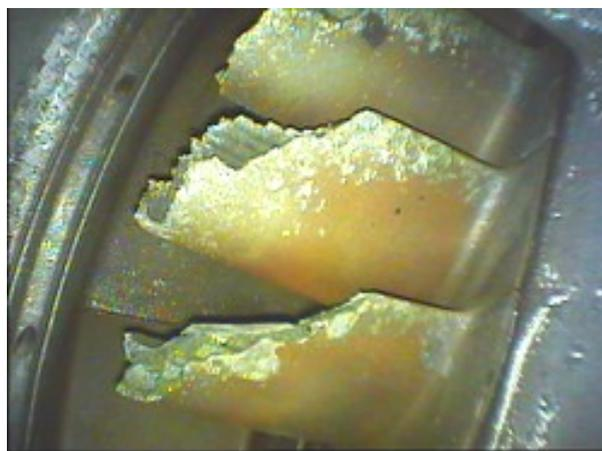
**Рис. 1.** Изношенные рабочие лопатки осевого компрессора двигателя ТВ3-117
