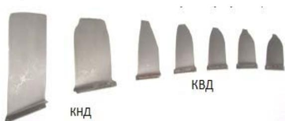
**Рис. 2.** Характер предельного износа рабочих лопаток компрессора со 2-й по 8-ю ступени
