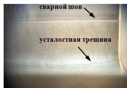
Рис. 5. Усталостная трещина на сегменте блиска
