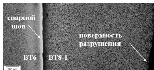
Рис. 4. Положение поверхности разрушения относительно сварного шва
