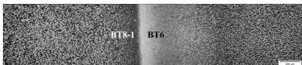
Рис. 1. Микроструктура сварного соединения макета блиска, изготовленного ЛСТ из сплавов и VT6 и VT8-1
