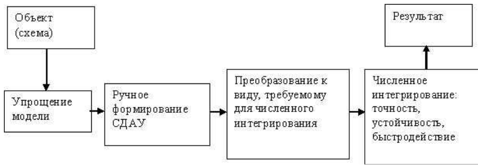
Рис. 1. Традиционный подход к моделированию схем силовой электроники
