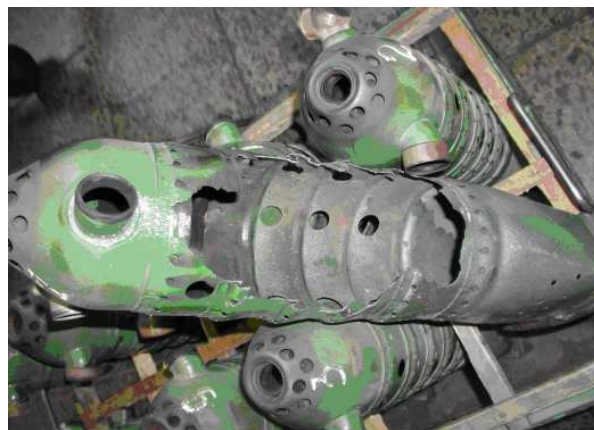
Рис. 2. Прогар жаровой трубы
