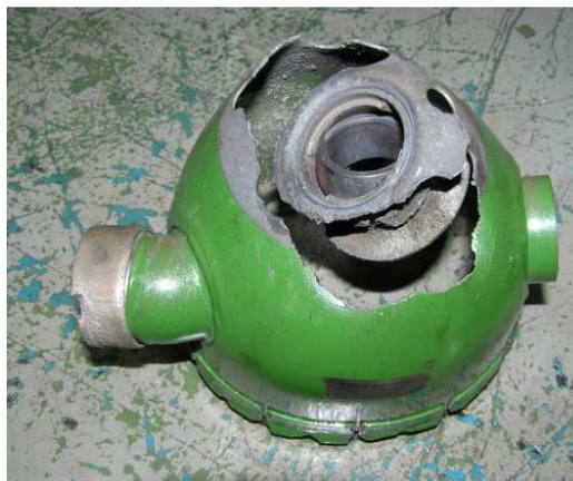
Рис. 1. Разрушение головки жаровой трубы
