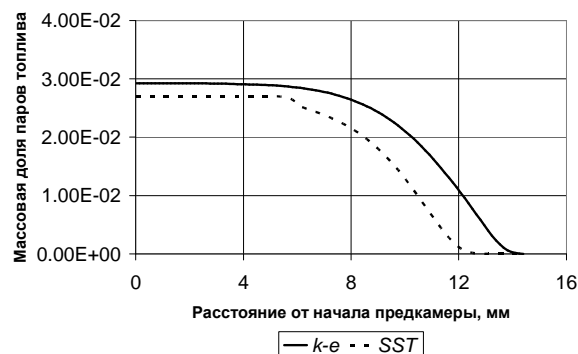
Рис. 11. Изменение массовой доли паров топлива на периферии предкамеры для модели турбулентности k-\varepsilon и SST
