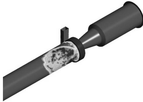
**Рис. 9.** Распределение объемной доли жидкой фазы в вихревой трубе
