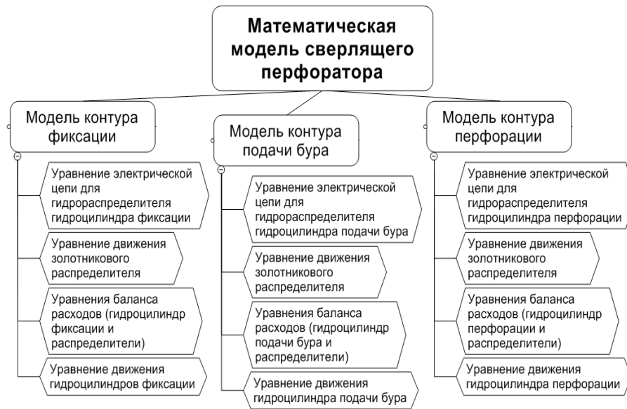
Рис. 2. Схема математической модели сверлящего перфоратора
