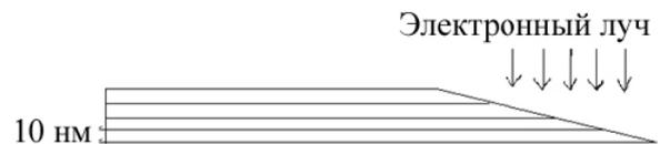
Рис. 3. Методика наблюдения фольги из многослойного покрытия в ПЭМ
