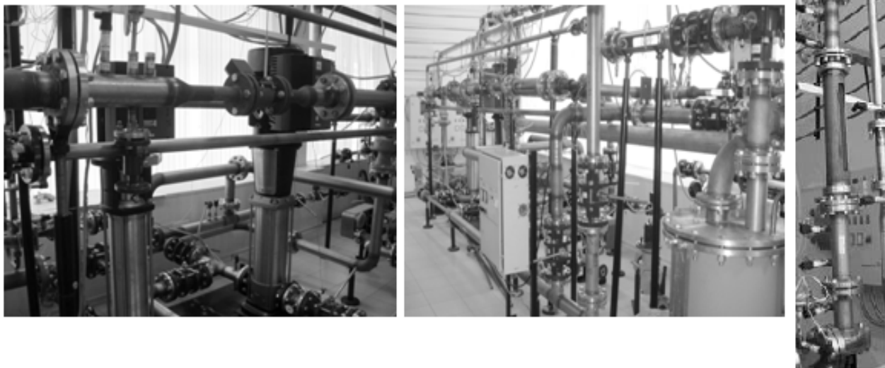
Рис. 6. Стенд «Гидродинамическое моделирование высокоскоростного многофазного течения жидкостей»: а – насосная станция; б – общий вид стенда; в – вихревой теплогенератор с узлом визуализации в вихревой трубе до крестовины
