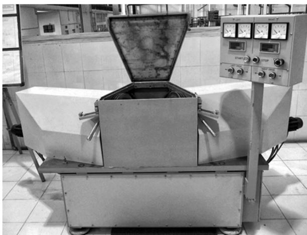
Рис. 9. Электрохимический станок с вибрирующими ЭИ и импульсным током для двусторонней обработки лопаток – «Искра»
