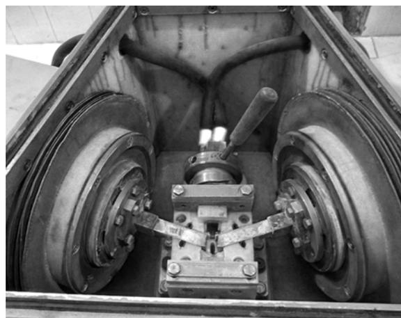
Рис. 2. Технологическая оснастка для обработки лопаток КВД изделия ВК-2500
