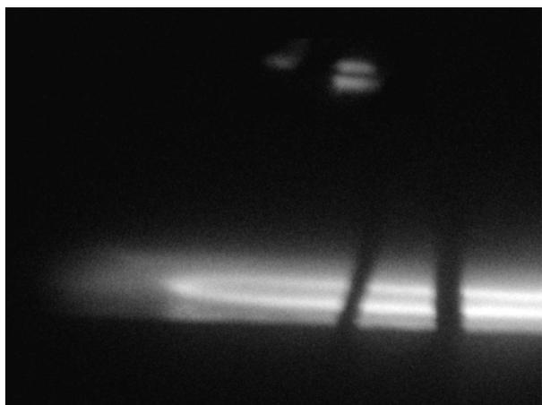
Рис. 1. Тлеющий разряд в магнитном поле при давлении 150 Па
