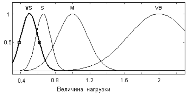
Рис. 4. Графики функций принадлежности для термов входной лингвистической переменной «Величина нагрузки»
