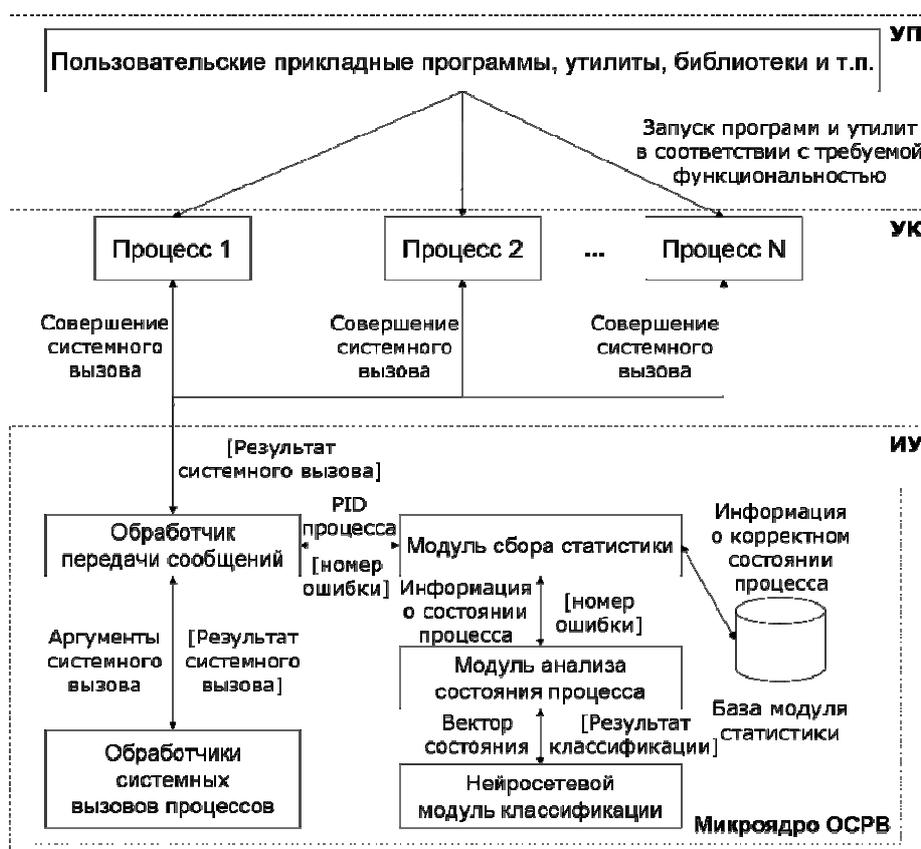
Рис. 3. Архитектура системы анализа состояния МОС на основе поведения процессов
