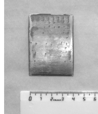
Рис. 1. Заготовка лопатки ГТД из композиционного материала на основе Mg-B
