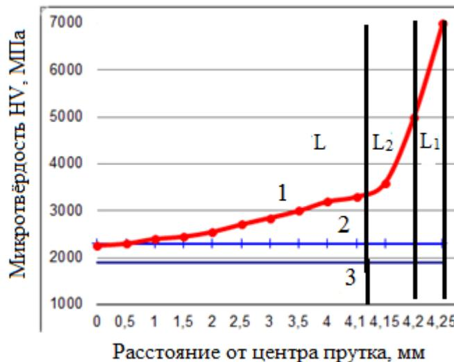
Рис. 3. Изменение микротвердости HV вдоль радиуса прутка стали 10: L, L<sub>1</sub>, L<sub>2</sub> – зоны деформационного влияния эксцентриковой фильеры; 1 – волочение со сдвигом,  $e > 1,5$ ; 2 – обычное волочение,  $e = 0,32$ ; 3 – исходное состояние
