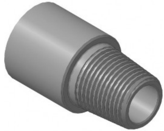
Рис. 1. Трехмерная модель ниппеля резьбовой части бурильной трубы
