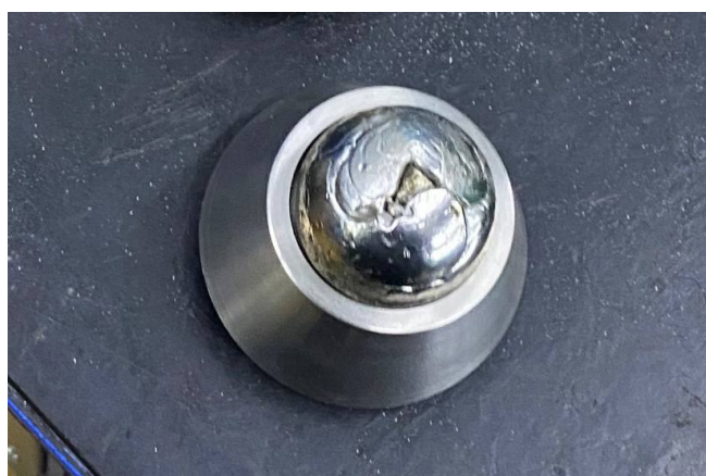
Рис. 1. Оснастка для крепления слитка из ВЭС
