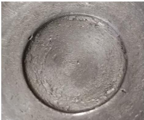
**Рис. 6.** Изображение поверхности нижнего бойка  $d = 10$  мм с канавкой после КВД образцов из стали. Отчетливо виден налипший на боек материал образца, создающий микронеровности
