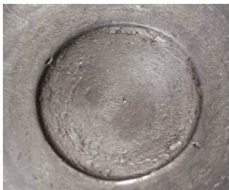
Рис. 7. Изображение поверхности нижнего бойка d 10 мм с канавкой после КВД образцов из стали. Отчетливо виден налипший на боек материал образца, создающий микронеровности
