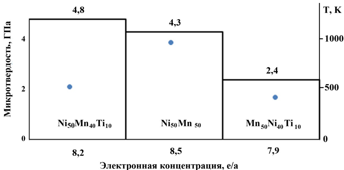
Рис. 1. Зависимость микротвердости (левая ось ординат) и температуры начала мартенситного превращения (правая ось ординат) от состава/электронной концентрации сплавов системы Ni–Mn–Ti
