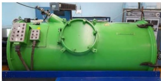
Рис. 1. Установка ионного азотирования ЭЛУ-5М
