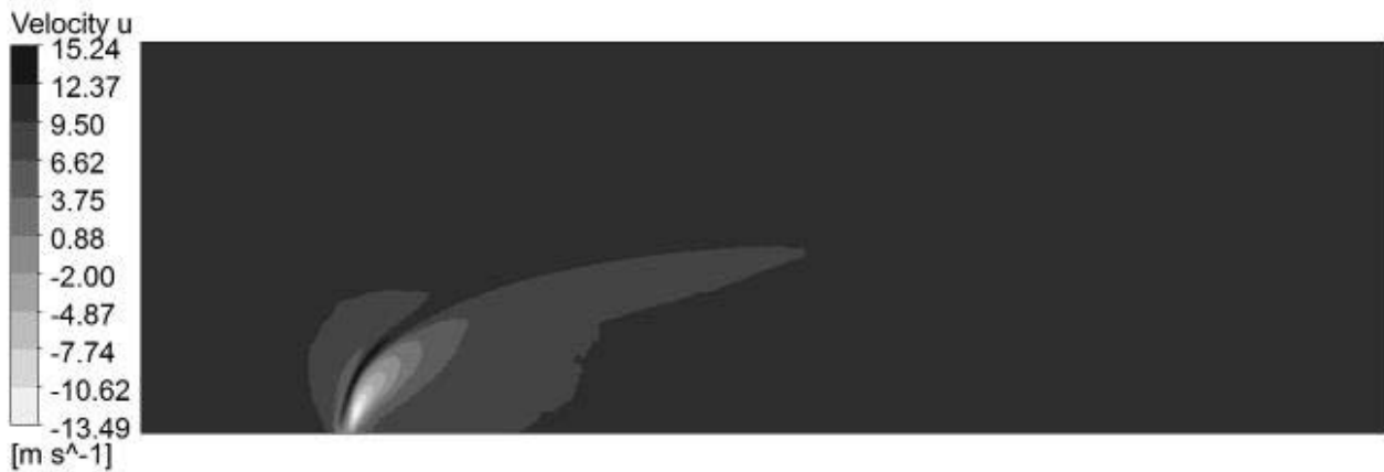
Рис. 5. Распределение проекции скорости на ось u в плоскости, проходящей через ось струи
