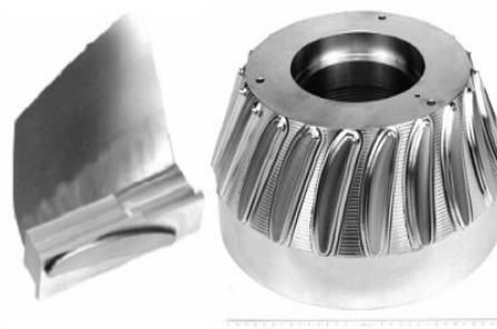
Рис. 1. Наличие симметричного рельефа на заготовках лопатки и диска для ЛСТ [2]
