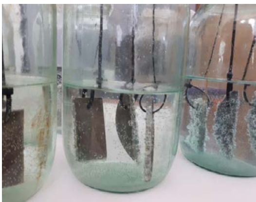
Рис. 1. Образцы во время выдержки в коррозионно-агрессивном растворе
