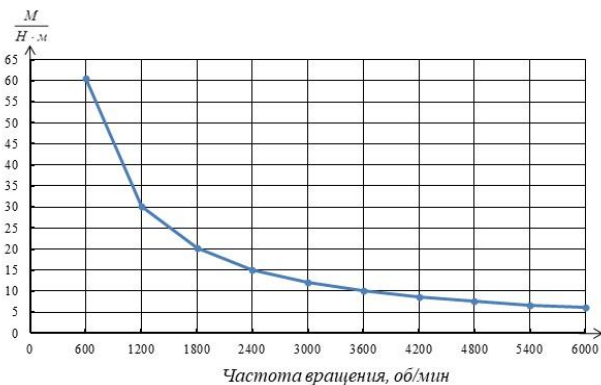
Рис. 2. Зависимость момента компрессора климатической установки мощностью 3,8 кВт от частоты вращения вала двигателя
