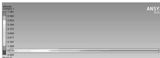
Рис. 7. Скорость течения жидкости при ламинарном течении
