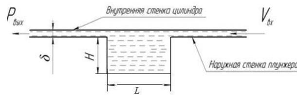
Рис. 9. Расчетная схема для моделирования плунжерной пары с прямоугольной формой канавки
