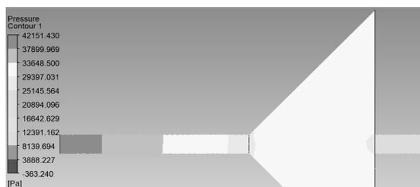
Рис. 14. Перепад давлений в плунжерной паре с треугольной канавкой
