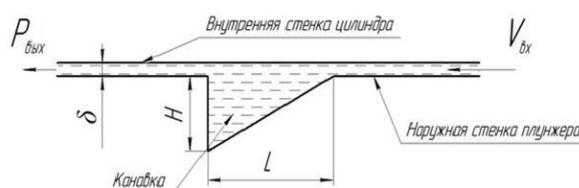
Рис. 13. Расчетная схема для моделирования плунжерной пары с треугольной формой канавки
