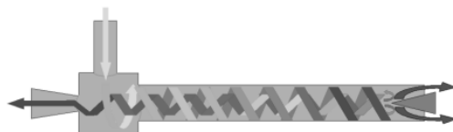
Рис. 2. Схема работы вихревой трубы Ранка-Хильша
