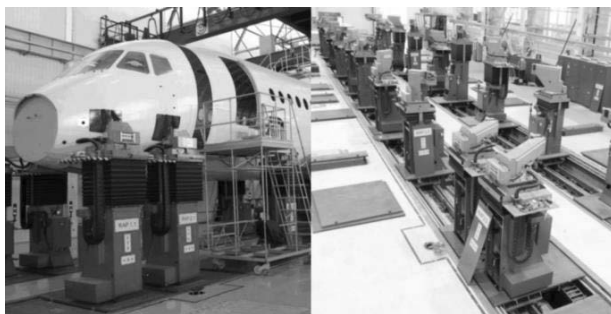
Рис. 2. Стенд стыковки частей фюзеляжа с помощью опорных колон
