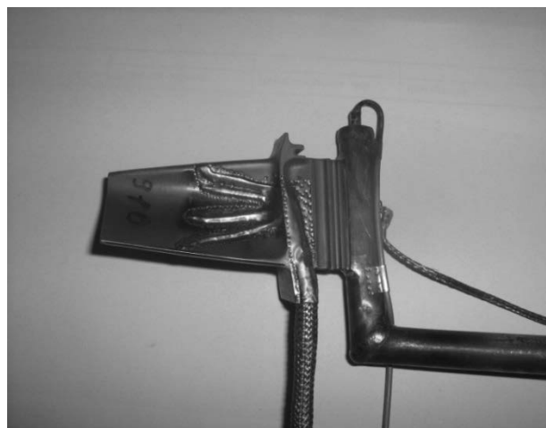
Рис. 8. Препарированная лопатка (среднее сечение)
