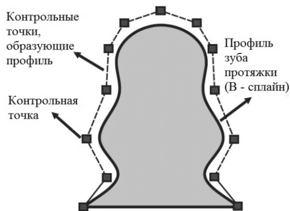
Рис. 2. Интерполяция режущей кромки зуба протяжки
