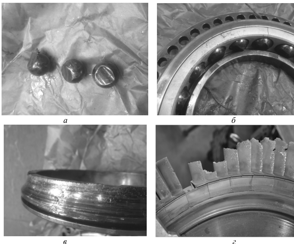
Рис. 1. Заклинивание шарикового подшипника ротора двигателя и его последствия: а – тела качения подшипника; б – наружное кольцо и сепаратор; в – внутреннее кольцо; г – диск турбины с рабочими лопатками
