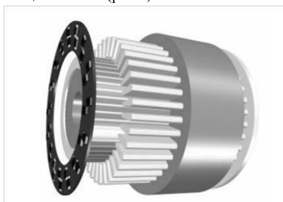
Рис. 1. Принципиальный эскиз машины со статорной клеткой
