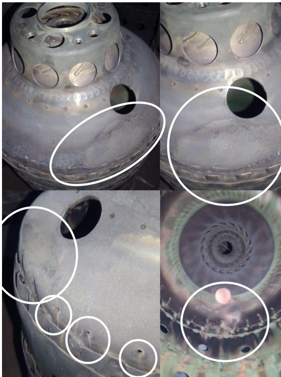
Рис. 3. Пузыри и трещины камеры сгорания ГТД-350, отмеченные белой окружностью
