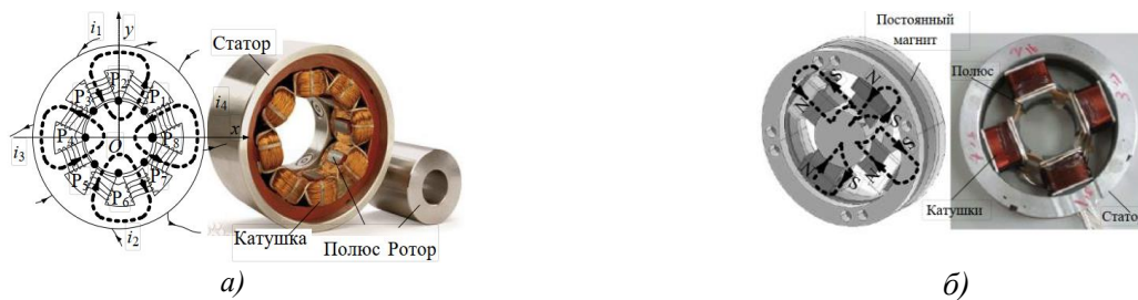
Рис. 2. Прототип и магнитная схема 4-полюсного РМП: а) – гетерополярные РМП; б) – гомополярные РМП
