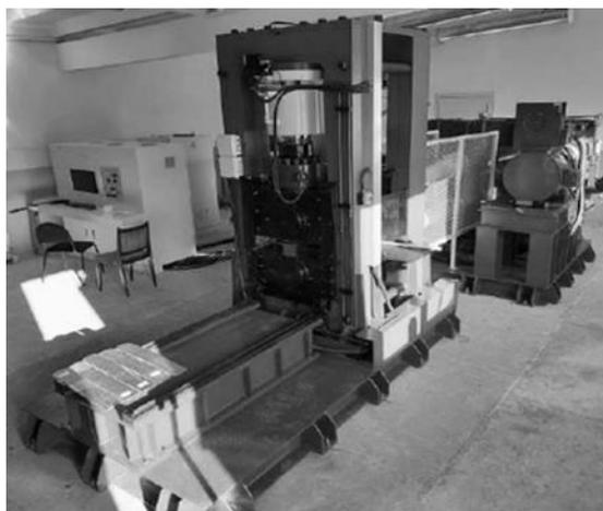
**Рис. 1.** Общий вид реверсивного стана ДУО 400 листовой прокатки с индивидуальным приводом рабочих валков
