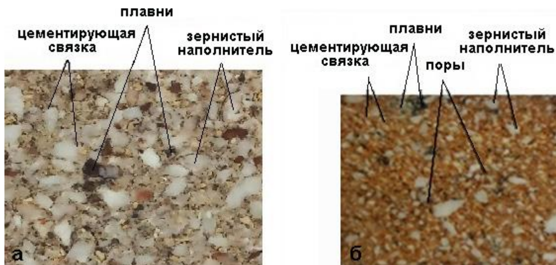
Рис. 8. Структура сколов образцов композиционных материалов из пиррофиллитового сырья месторождения Куль-Юрт-Тау, изготовленных с применением силикатного связующего (а) и фосфатного связующего (б)
