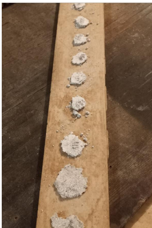
Рис. 6. Внешний вид испытанных на текучесть образцов после термической обработки (образцы приведены по порядку изменения температуры), °С: 20, 50, 100, 120, 150, 150, 200, 250, 300
